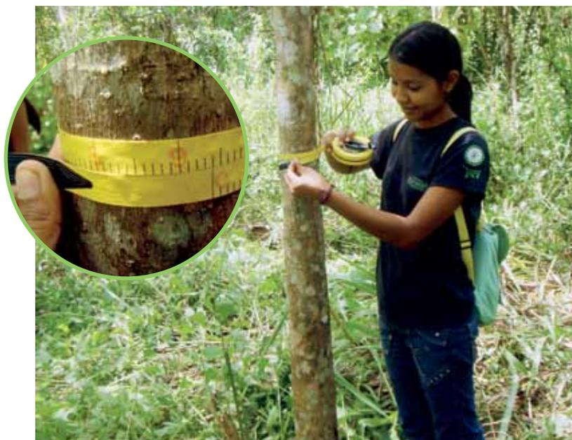
**Figura 3.2.** Obsérvese la altura (1,30 m) para medir el dap utilizando, en este caso, cinta diamétrica
